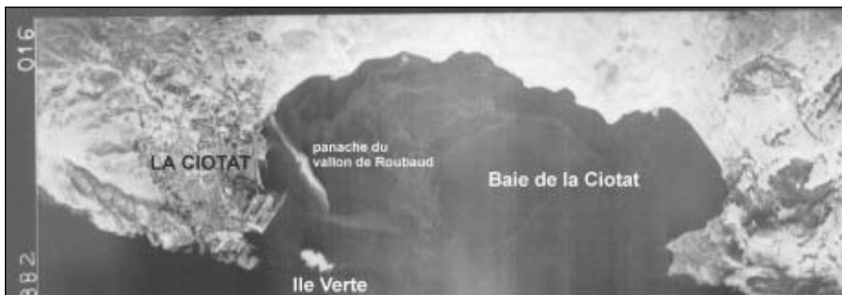
Figure 20 : Thermographie aéroportée (février 1971) : le panache blanc (eaux froides) correspond aux eaux du vallon de Roubaud. Aucune venue chaude profonde (couleur noire) n'est visible à l'est de l'Ile Verte
