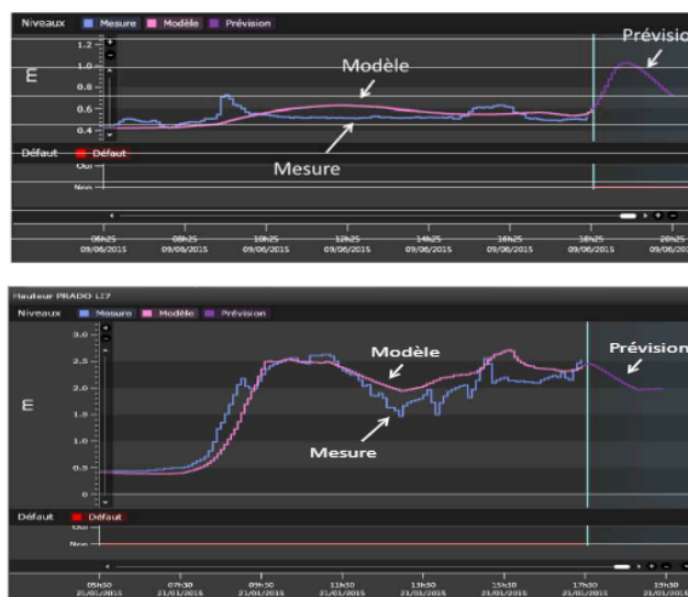
Figure 4 : Comparaison des hauteurs d'eau calculées et modélisées par temps de pluie et prévision 1 h
