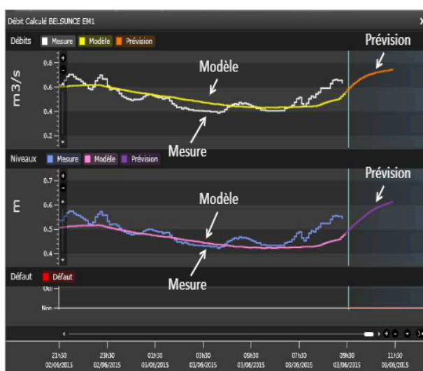
Figure 2 : Comparaison des débits et hauteurs d'eau mesurés et modélisés par temps sec et prévision 1h
