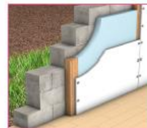
Exemple d'isolation par l'intérieur
