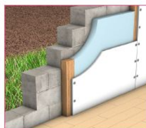
Exemple d'isolation par l'intérieur
