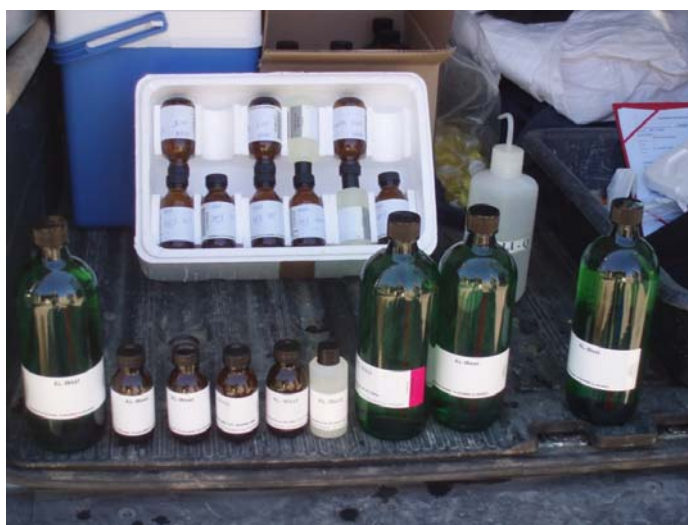
Illustration 8 : Flacons de prélèvements d'eau
